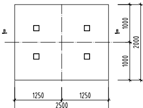
构架钢柱基础平面图
