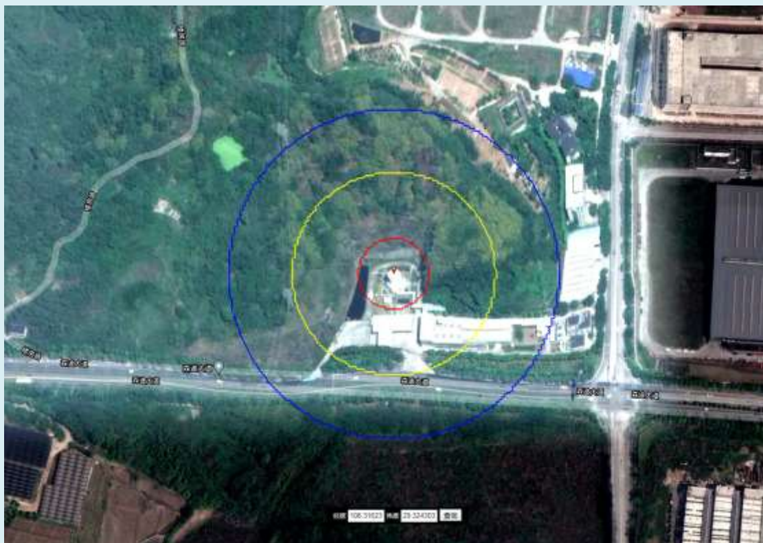
图 7.1-1 恒盛能源 LNG 储罐周边区域个人风险等值线分布示意图
