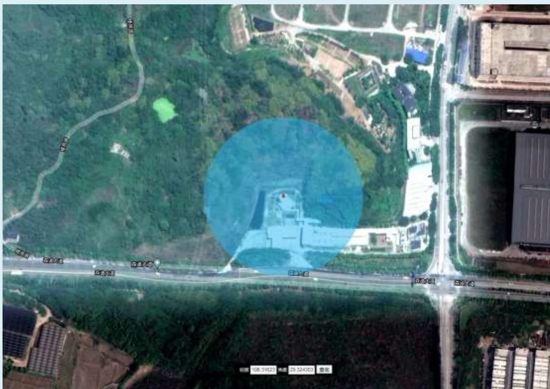
图 7.3-9 恒盛能源公司 LNG 储罐多米诺半径模拟结果图
