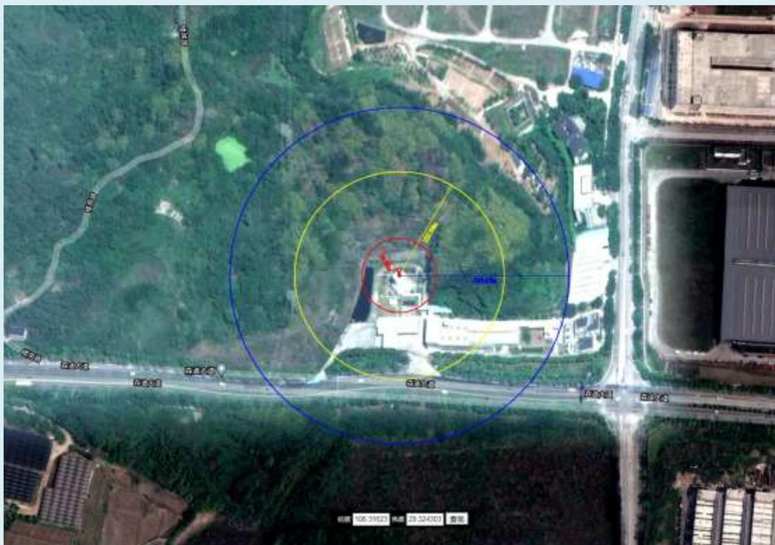
图 7.3-11 恒盛能源生产装置和储存设施外部安全防护距离图
