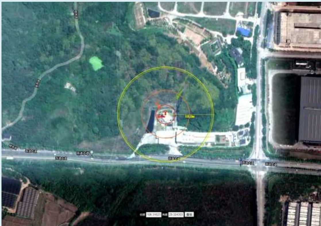
图 7.3-2 恒盛能源 LNG 储罐中孔泄漏蒸气云爆炸事故后果模拟图
