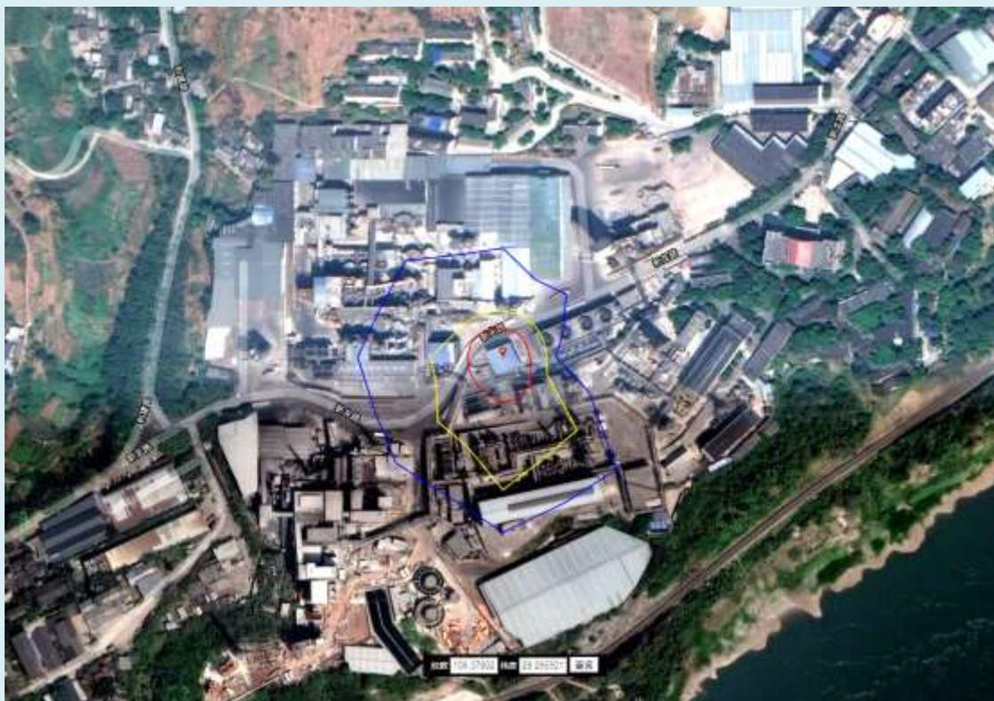
图 7.3-12 和友实业生产装置和储存设施外部安全防护距离图
