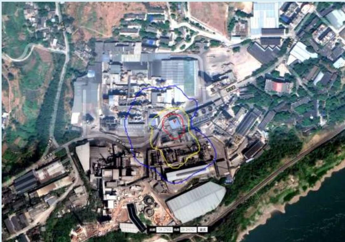
图 7.1-2 和友实业液氨储罐周边区域个人风险等值线分布示意图
