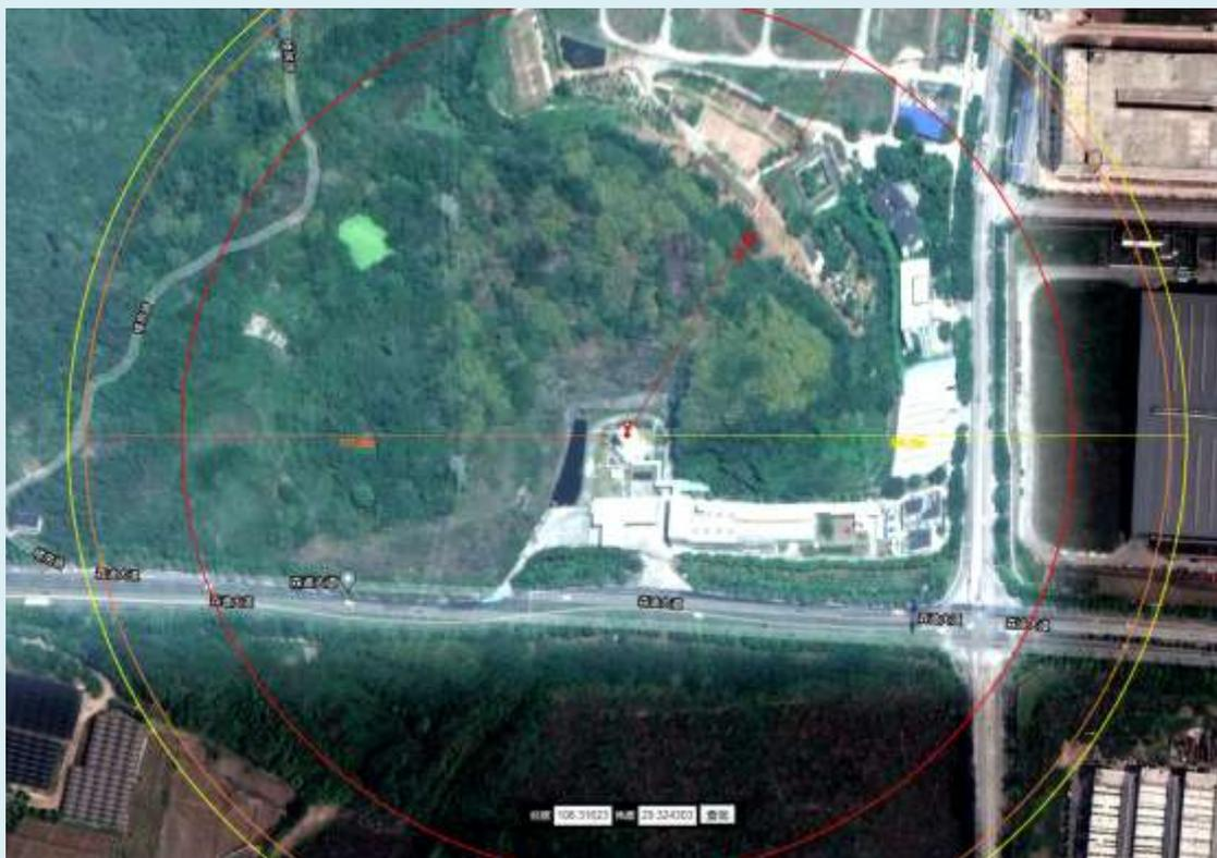
图 7.3-3 恒盛能源 LNG 储罐沸腾液体扩展蒸气爆炸事故后果模拟图
